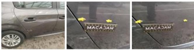
Aile ARD, Bosse(s) et griffe(s), LI - Réparer et peindre (complet)
