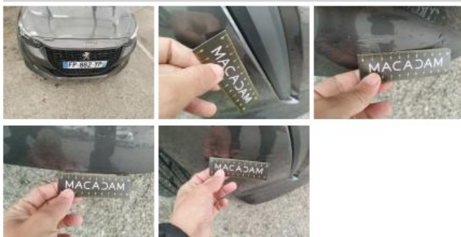
Porte AVD, Bosse(s) et griffe(s), LI - Réparer et peindre (complet)
