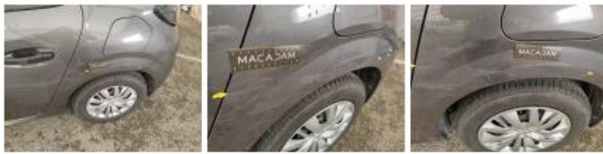
Porte ARG, Bosse(s) et griffe(s), LI - Réparer et peindre (complet)
