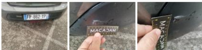
Jupe AR, Déformé / Forcé, E - Remplacer
