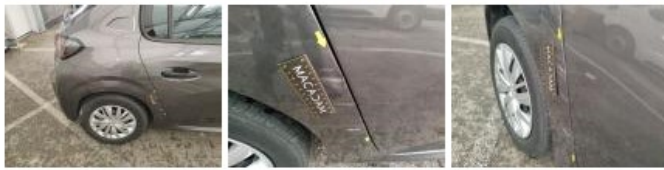
Aile ARD, Bosse(s) et griffe(s), LI - Réparer et peindre (complet)
