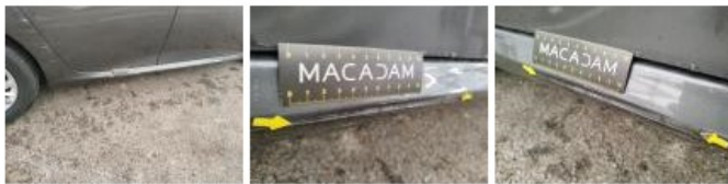
Jupe AR, Déformé / Forcé, E - Remplacer
