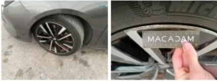
Jante alu ARD bi-ton/polychrome, Griffe(s), Réparer/remplacer (montant forfaitaire)
