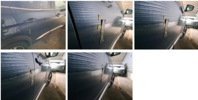
Porte AVD, Bosse(s), LI - Réparer et peindre (complet)
