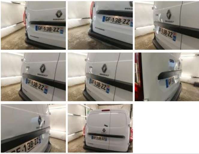
Porte de malle AR D, Bosse(s), LI - Réparer et peindre (complet)
