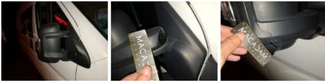
Feu ARG, Fêlure, E - Remplacer
