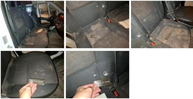
Revêtement assise siège AVD, Brûlé, E - Remplacer
