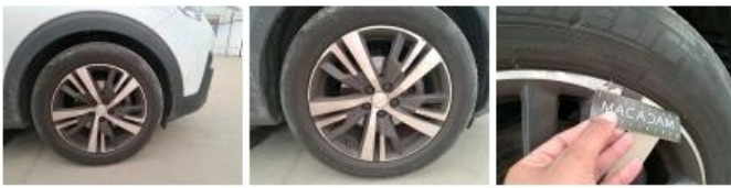
Pneu AVD, Déchirure, E - Remplacer
