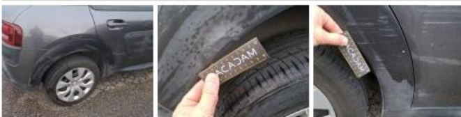
Porte ARD, Bosse(s) et griffe(s), LI - Réparer et peindre (complet)
