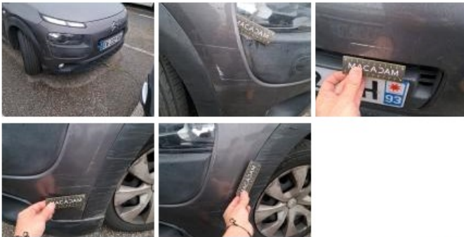
Moulure de pare-chocs AV, Cassé, E - Remplacer
