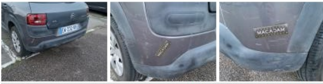
Moulure de pare-chocs AR, Déformé / Forcé, E - Remplacer
