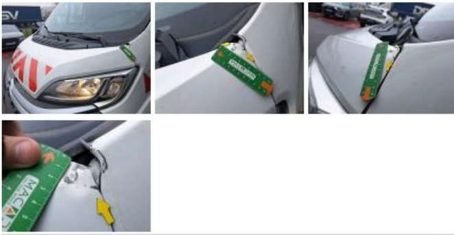
Moulure de panneau latéral D, Manque, E - Remplacer
