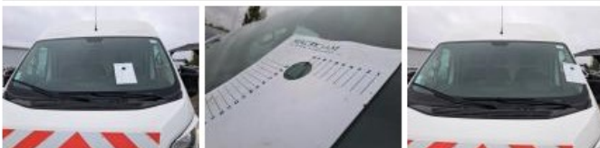
Pare-brise, Eclat(s), E - Remplacer
