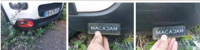
Moulure de pare-chocs AV, Griffe(s), E - Remplacer
