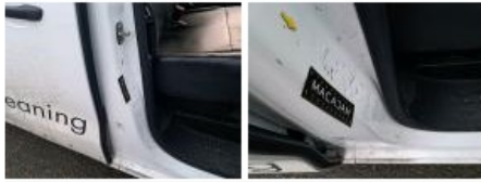
Bas de caisse int AVD, Bosse(s) et griffe(s), LI - Réparer et peindre (complet)
