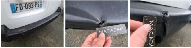
Coin pare-chocs ARD, Déformé / Forcé, E - Remplacer
