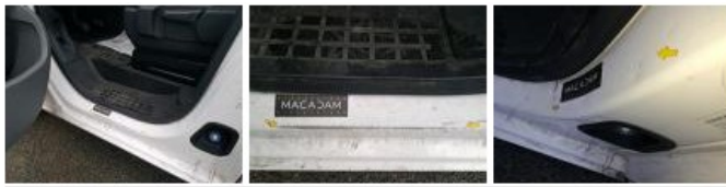
Bas de caisse int AVD, Bosse(s) et griffe(s), LI - Réparer et peindre (complet)
