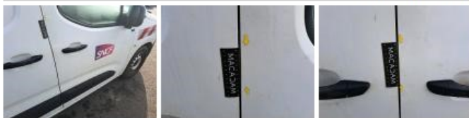
Porte de malle AR G, Bosse(s) et griffe(s), LI - Réparer et peindre (complet)
