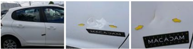
Bas de caisse ext D, Bosse(s), LI - Réparer et peindre (complet)
