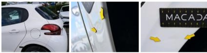
Bas de caisse ext G, Bosse(s) et griffe(s), LI - Réparer et peindre (complet)
