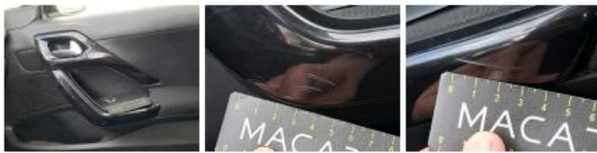
Grille vent. M, Endommagé, E - Remplacer
