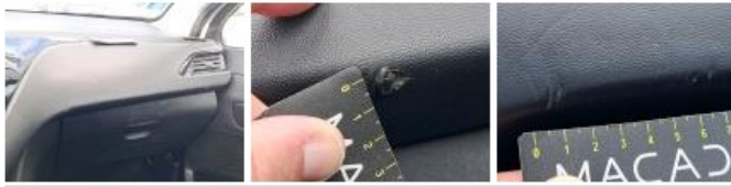
Console centrale, Griffe(s), Réparer/remplacer (montant forfaitaire)
