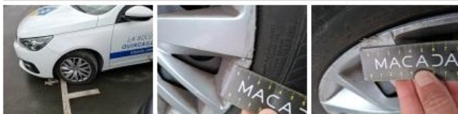
Pneu ARD, Déchirure, E - Remplacer
