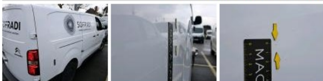
Panneau ARD, Bosse(s) et griffe(s), LI - Réparer et peindre (complet)
