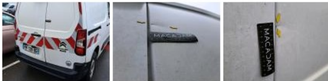
Porte de malle AR D, Bosse(s) et griffe(s), Acceptable
