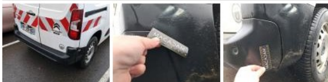
Coin pare-chocs ARD, Déformé / Forcé, LI - Réparer et peindre (complet)
