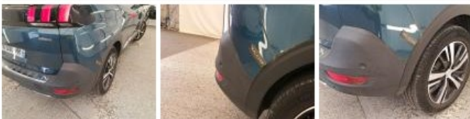
Coin pare-choc ARD, Déformé / Forcé, LI - Réparer et peindre (complet)
