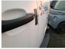
Porte de malle AR G, Bosse(s) et griffe(s), PDR - Débosselage ss peinture
