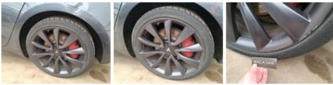
Pneu ARG, Déchirure, E - Remplacer
