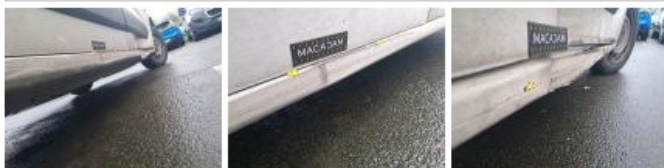
Bas de caisse ext D, Bosse(s) et griffe(s), Le - Remplacer et peindre
