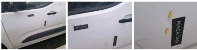
Panneau ARG, Bosse(s) et griffe(s), LI - Réparer et peindre (complet)
