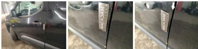
Moulure porte AVG, Griffe(s), E - Remplacer
