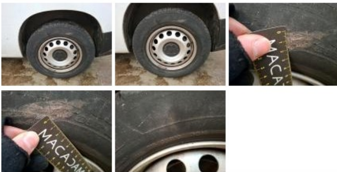
Pneu ARD, Déchirure, E - Remplacer
