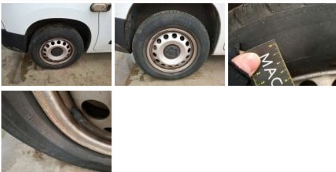
Pneu AVD, Déchirure, E - Remplacer
