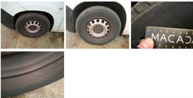
Pneu ARG, Déchirure, E - Remplacer
