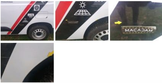
Bas de caisse ext D, Bosse(s), LI - Réparer et peindre (complet)
