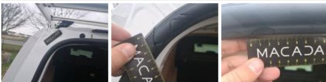
Porte de malle AR D, Bosse(s) et griffe(s), Acceptable
