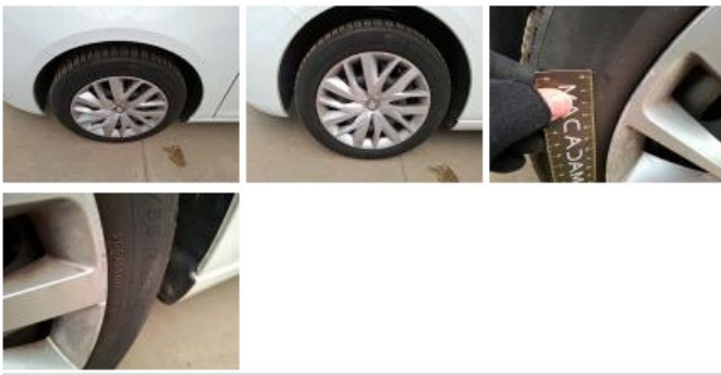
Pneu ARG, Déchirure, E - Remplacer
