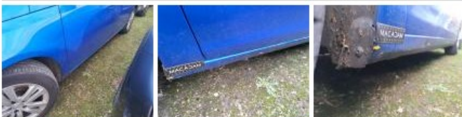
Bas de caisse ext G, Bosse(s), LI - Réparer et peindre (complet)
