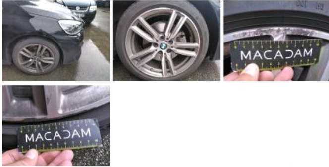
Pneu AVD, Déchirure, Acceptable
