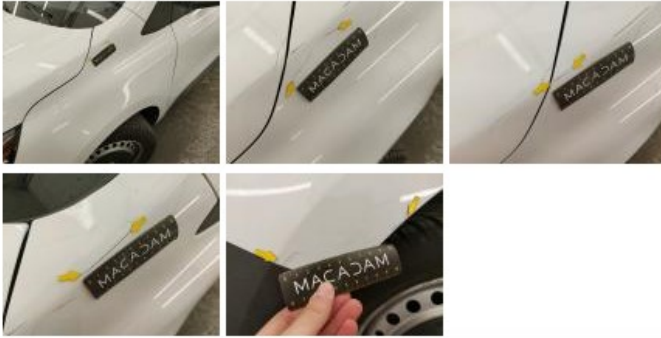
Panneau Latéral G, Bosse(s), LI - Réparer et peindre (complet)
