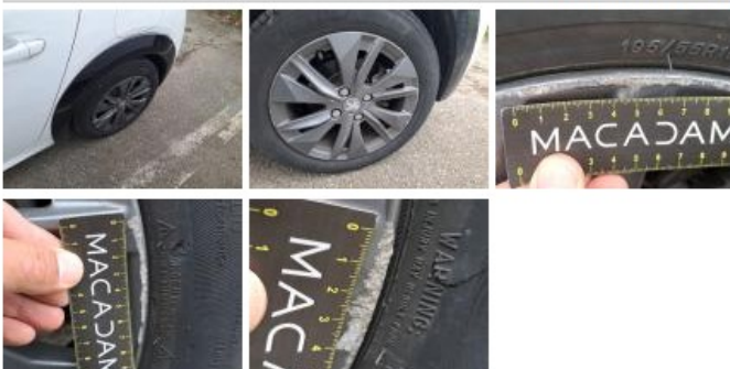
Pneu ARG, Déchirure, E - Remplacer
