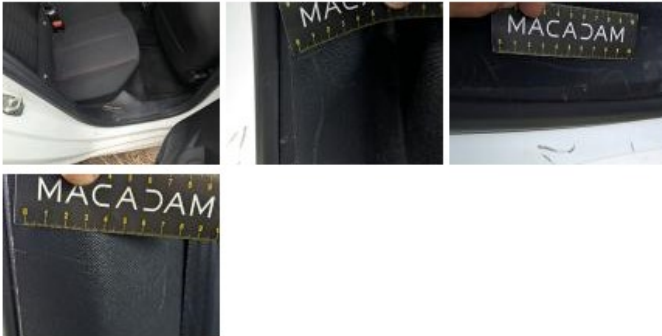
Console centrale, Résidu de colle, Acceptable
