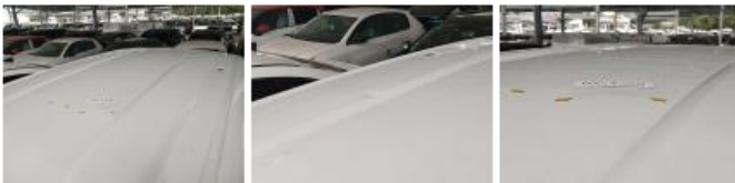
Pavillon caisse, Bosse(s), LI - Réparer et peindre (complet)
