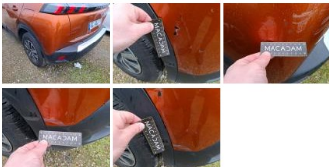
Pare-chocs AR, Griffe(s), E - Remplacer
