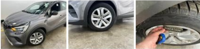
Enjoliveur de roue AVG, Déformé / Forcé, Acceptable
