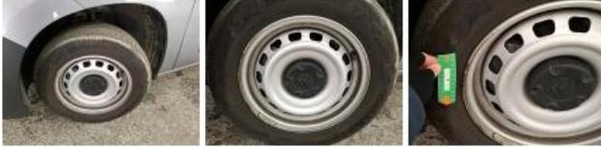
Pneu ARD, Déchirure, E - Remplacer
