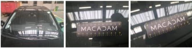
Pare-brise, Eclat(s), E - Remplacer
