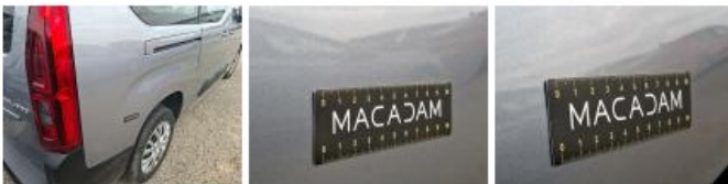
Porte coulissante D, Différence de teinte, Peindre
