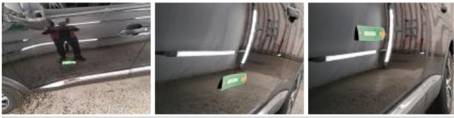
Aile ARG, Mauvaise réparation, Peindre
