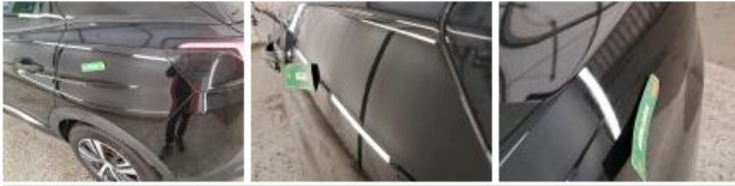
Porte ARD, Mauvaise réparation, Peindre
