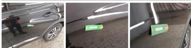
Porte AVG, Mauvaise réparation, Peindre
