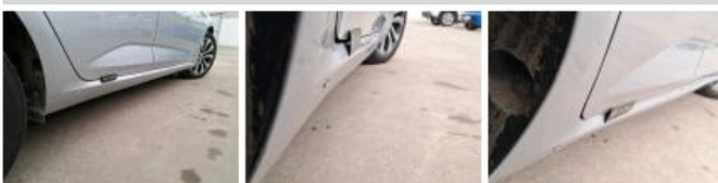
Bas de caisse ext D, Mauvaise réparation, Acceptable
