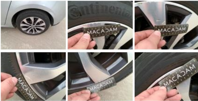
Pneu ARG, Déchirure, E - Remplacer
