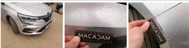
Bas de caisse ext D, Mauvaise réparation, Acceptable
