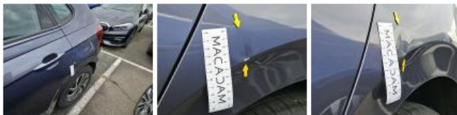
Aile ARG, Bosse(s) et griffe(s), LI - Réparer et peindre (complet)
